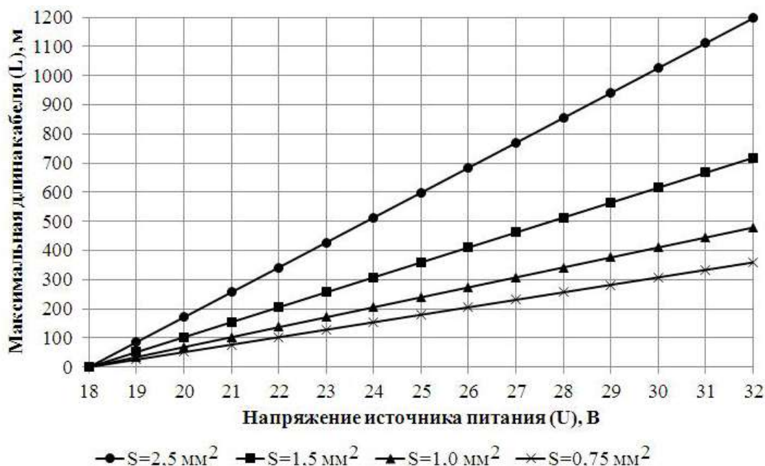
Рисунок 2.2 – Типовая зависимость максимально допустимой длины кабеля между газоанализатором и источником питания
